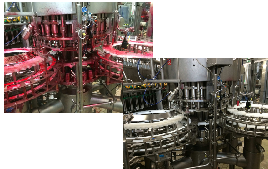
„Shadow Test” monobloku, na podstawie którego dobierane są odpowiednie parametry i sekwencje mycia
