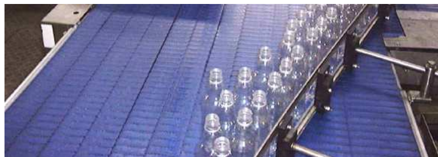
Transport butelek smarowany przy wykorzystaniu technologii suchej Diversey
