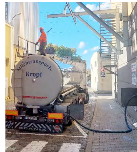
Fot. 2. System asekuracji pracy na wysokości dla kierowców cystern
